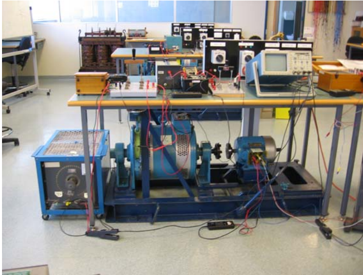
Figure 5.1 IM Test Bed
