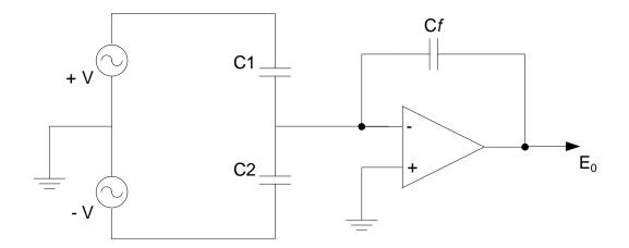
Figure 5-9. Capacitance bridge.
