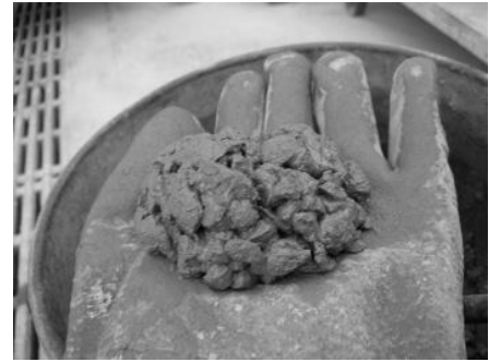
(d) 0.40 Too wet
