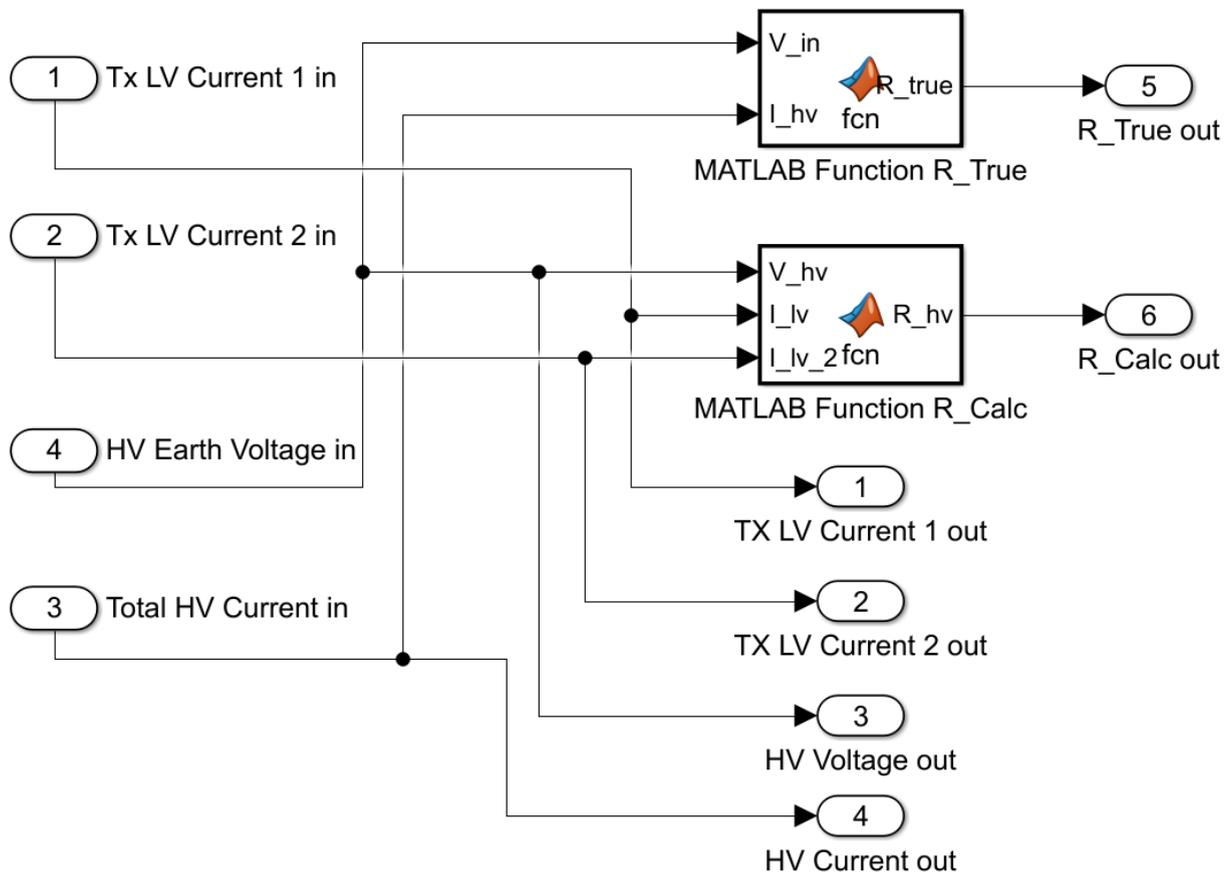
**Figure 106: HV Earth Monitoring Subsystem Model**
