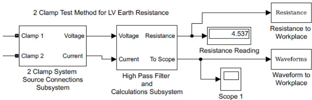
**Figure 101: Two Clamp LV Earth Test Model**
